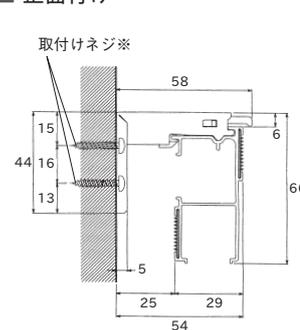
※ 取付けネジは下地位置の状況に応じて図のどちらかの位置に取付けてください。
