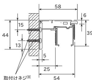
※ 取付けネジは下地位置の状況に応じて図のどちらかの位置に取付けてください。
