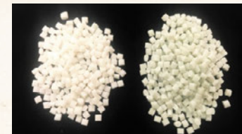
左:国内再生ペットボトルチップ※ 右:輸入再生ペットボトルチップ
