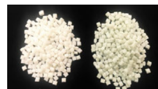
左:国内再生ペットボトルチップ※ 右:輸入再生ペットボトルチップ ※ペットボトルから糸を作る段階で粉碎(フレーク・チップ)してから糸をつくります。
